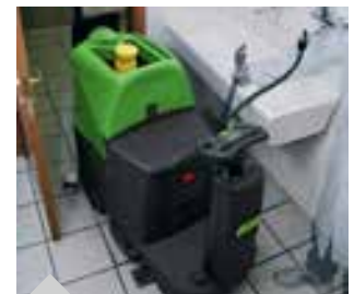
Tanque água limpa com mangueira para facilitar o enchimento do tanque
