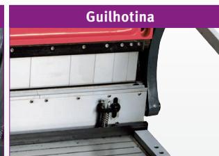
▶ Corte limpo sem limalhas, graças à lâmina superior e inferior em aço de qualidade
