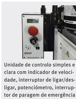
Unidade de controlo simples e clara com indicador de velocidade, interruptor de ligar/desligar, potenciômetro, interruptor de paragem de emergência
