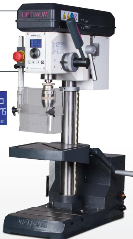
\*O engenho de furar (inversor de frequência) está em conformidade com a norma DIN EN 55011: Classe C2. Consulte o verso para obter mais informações sobre a operação de máquinas com inversor de frequência
