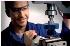
A pré-furação térmica cria uma bucha pela deformação do material existente, sem farpas originadas pelo calor da fricção, a bucha é rosçada com o macho deformante.
