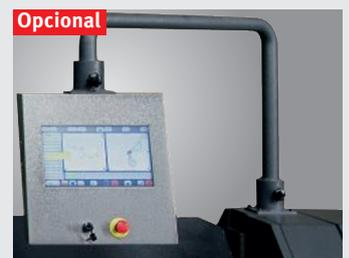
▶ **Controlo CNC opcional com gráficos 3D**, os perfis são feitos pelo operador num generoso ecrã touch de 19"; Todas as posições dos eixos e a sequência de flexão são calculadas pelo controlo, batente traseiro motorizado com paragem de dedos, percurso 15-1 000 mm
