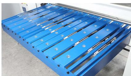
Mesa de apoio retangular de dimensões generosas na área traseira com esferas de transferência integradas para facilitar o manuseio do material
