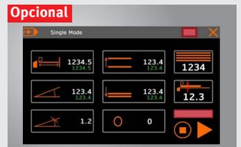
▶ **Controlo opcional Schneider NC2**, controlo de três eixos para entrada digital de ângulo, entrada da posição do batente traseiro e posição da abertura do segmento superior, possível armazenamento de sequências de dobra, batente traseiro motorizado, curso de 15-1000mm
