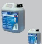
Misturar com água. 5% óleo = Para aços de construção standard e metais NE, 10% Óleo = Para aços altamente duros e aço inoxidável. Para trabalhos mais exigentes pode misturar até 50% Óleo na água. Poderá usar o óleo sem ser misturado. Por exemplo para encher as bombas de pressão de refrigeração Karnasch.
