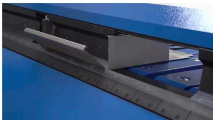
Adequado para a produção de caixas altas com uma altura lateral de 170 mm e espessura de material até 4 mm - alturas laterais até 200 mm possíveis com opcional
