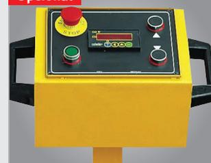
▶ Consola de controlo com display digital e alimentador do rolo lateral motorizado
