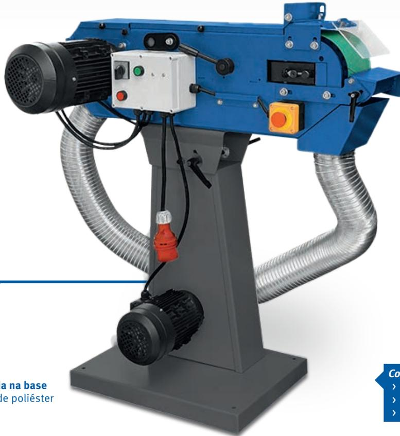
Extração integrada na base com saco de filtro de poliéster
