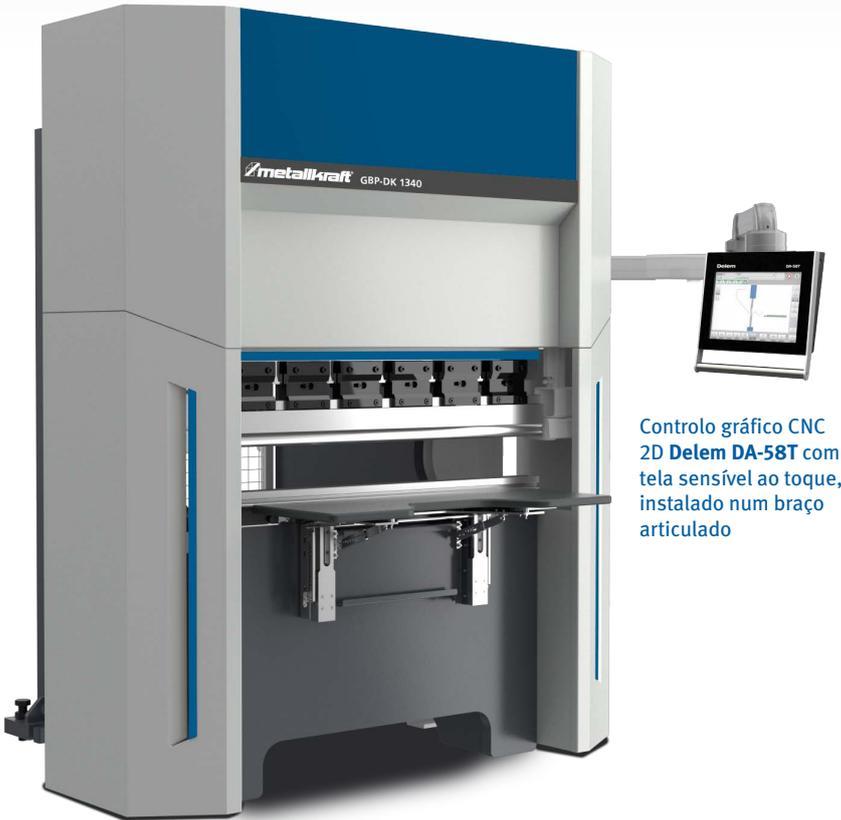
Controlo gráfico CNC 2D Delem DA-58T com tela sensível ao toque, instalado num braço articulado
