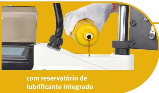
com reservatório de lubrificante integrado
