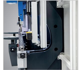
▶ *Compensação motorizada, controlado por CNC*
