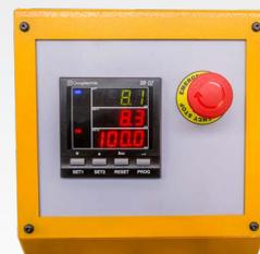
▶ Painel de controlo com display digital e interruptor de paragem de emergência
