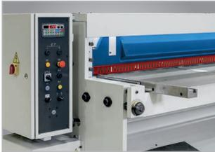
▶ Suporte de chapa pneumático com alavanca seletora para a direção da calha de chapa. O operador pode escolher se a secção cortada cai na traseira ou ao lado do operador
