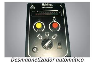
Desmagnetizador automático para base eletromagnética
