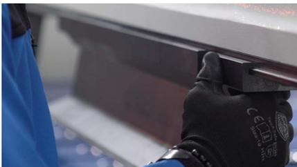
Tempos de preparação muito rápidos graças à fixação pneumática das ferramentas superiores segmentadas (opcional)
