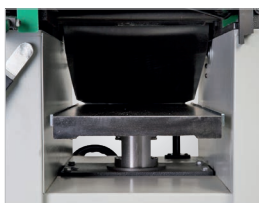
Ajustamento da mesa através de volante, escala e display numérico
