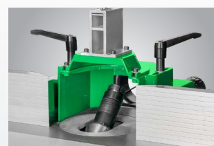
Fuso fresador retrai para uso de dispositivo de alimentação, segurança máxima e qualidade de fresagem
