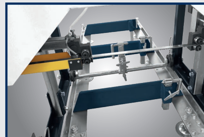
• Cortes precisos graças à guia de fita de serra ajustável
