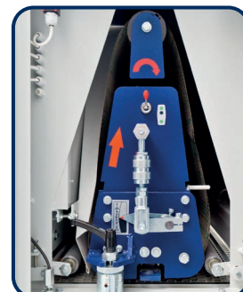
Rolo de aço com nervuras Ø 120 mm e sapato de lixar duro com revestimento de grafite
