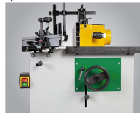
Volante para ajuste de altura dispositivo de segurança incluído
