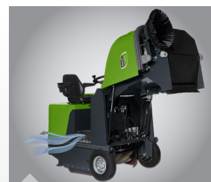
Esvaziamento do contentor hidráulico subindo até 1,4 m de altura
