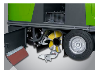
Escovas substituíveis sem necessidade de ferramentas
