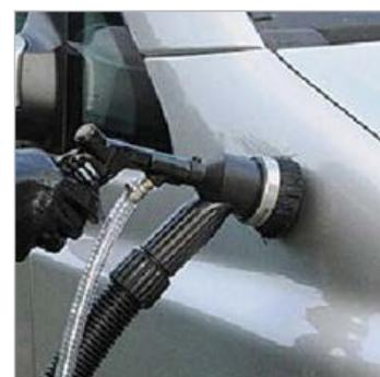
▶ O agente decapante é aspirado imediatamente após atingir a superfície
