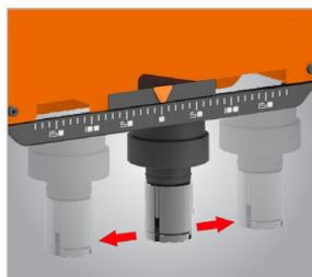
Cilindro móvel lateralmente com visor de escala
