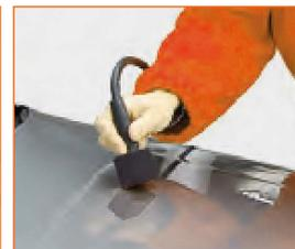
▶ Para remoção de moças sem danificar a pintura
