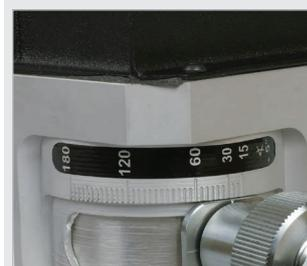
▶ Ângulo de lixagem infinitamente ajustável de 15-180
