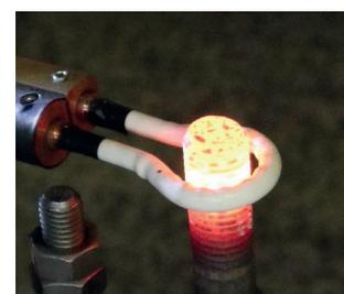
▶ Aquecimento de um parafuso roscado com a bobina refrigerada a água
