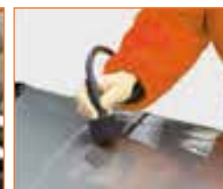
▶ Para remoção de mossa sem danificar a pintura
