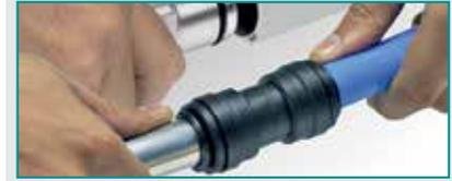
Embora geralmente recomendamos a utilização de tubos de plástico ou alumínio, também é possível utilizar tubos de outros materiais (cobre, latão, etc.) com nossos conectores. Assim, os sistemas de redes de tubos existente pode ser modificado ou estendido usando conectores AIRCRAFT
